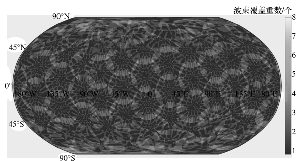
图 5 铱星星座网络采用波束关闭策略后对地覆盖分布
